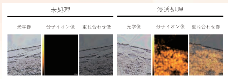
(例) 爪痕跡への浸透評価 塗布溶液：爪用美容液 試料：ヒト爪 (オレンジ色で示す舞点は爪用美容液成分に由来する分子イオン分布を示す)
